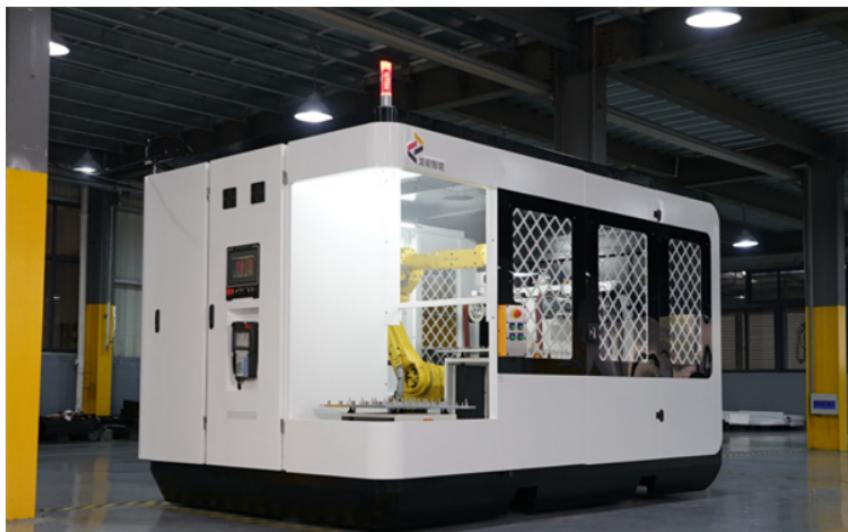
机器人搭配力控打磨工具主要优点：提高打磨质量和产品光洁度，保证其一致性；提高生产率，24小时可24小时连续生产；改善工人劳动条件，可在有害环境下长期工作；降低对工人操作技术的要求；缩短产品改型换代的周期，减少相应的投资设备；可再开发性，用户可根据不同样件进行二次编程。总的来说，很多铸件要人工打毛刺，不只费时，打磨效果不好，效率低，而且操作者的手还常常受伤。而打磨机器人根据被加工零部件光洁度要求配置不同的打磨机和磨头。具有可长期进行打磨作业、保证产品的高生产率、高质量和高稳定性等特点。打磨抛光机器厂家直供运用机器人打磨，产品光洁度、确保其一致性、进步出产率等具有良好的效果。
